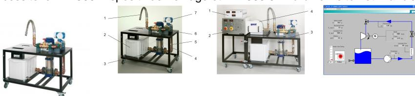
Avec l'unité d'alimentation HM 365.32, associée à HM 365.31, il est possible de faire fonctionner et d'étudier le comportement caractéristique de fonctionnement d'une turbine Pelton et d'une turbine Francis.
