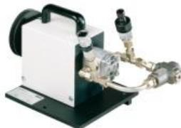
Les pompes à engrenages sont souvent utilisées comme pompes à huile dans les véhicules.
