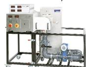
Le HM 365 est le module de base de la série FEMLine; il permet de réaliser des études et des expériences sur des machines à fluide.
