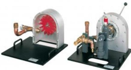
Les turbines à eau sont des turbomachines qui servent à utiliser l'énergie hydraulique.
