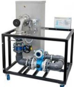
Sur la pompe axiale, le milieu de transport traverse la roue (ici en forme d'hélice) dans la direction axiale. La montée en pression a lieu sur les pompes axiales non pas sous l'effet de la force centrifuge, mais de manière similaire au principe aérodynamique, sur la pale d'hélice.
