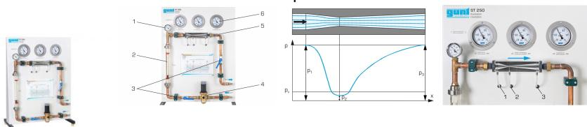
On appelle cavitation le phénomène de formation de bulles de vapeur dans des liquides en écoulement suite à de fortes dépressions.
