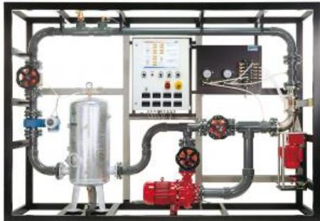
L'élément central de l'installation d'essai est la turbomachine axiale avec moteur asynchrone accouplé.
