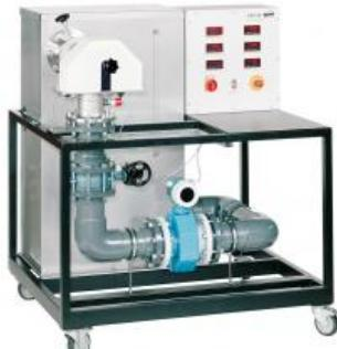
**HM 421 Banc d'essai turbine Kaplan, 4 aubes mobiles
