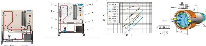
L'enregistrement des débits joue un rôle central dans de nombreuses installations de génie des procédés. On utilise pour cela différents débitmètres en fonction du milieu et de l'application.
