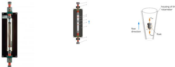
Le rotamètre (débitmètre à section variable) est monté dans le circuit deau du banc dessai HM 500.
