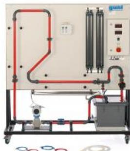
**HM 500 Banc d'essai pour débitmètres avec circuit d'eau fermé (Réf. 070.50000)**
