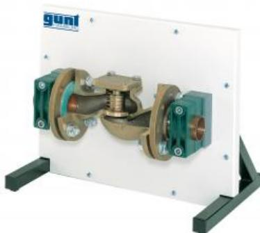
Véritable soupape de retenue transformée en modèle en coupe.
