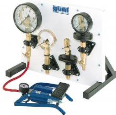
Le panneau de démonstration est équipé d'un manomètre à tube-ressort et d'un manomètre à ressort à lame. Outre les manomètres entièrement opérationnels, le mécanisme des deux manomètres est présent séparément une deuxième fois, le principe de fonctionnement étant mis en valeur.
