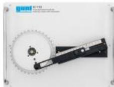
Un mécanisme bielle-manivelle est un groupe fonctionnel que l'on trouve dans des machines et qui sert à transformer un mouvement de rotation (rotatif) uniforme en un mouvement de va-et-vient (translationnel) et inversement.
