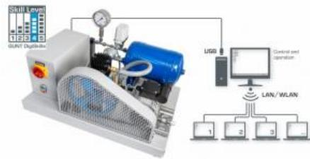
Le dispositif dessai MT 142 est utilisé avec lexercice de montage du compresseur à piston MT 141.
