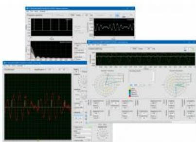
L'analyseur de vibrations assisté par ordinateur a été développé spécialement pour permettre l'interprétation des essais pour le diagnostic de machine de la série PT 500. Mais l'appareil de mesure peut également être utilisé avec profit pour de nombreux autres essais relatifs aux vibrations (p. ex. TM 150).
