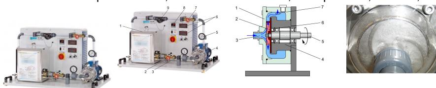
Les objets en mouvement rapide dans l'eau comme les roues d'une pompe centrifuge constituent l'une des causes les plus fréquentes des phénomènes de cavitation.
