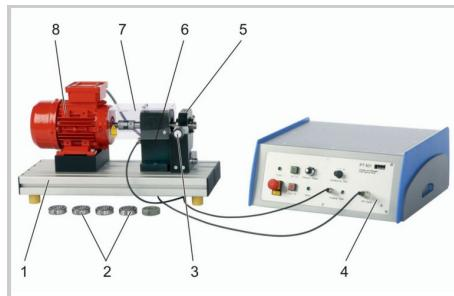
1 plaque de fondation, 2 palier à roulement, 3 dispositif de commande, 4 appareil de commande, 5 accueil du palier à étudier, 6 logement de l'arbre, 7 couvercle transparent, 8 moteur
