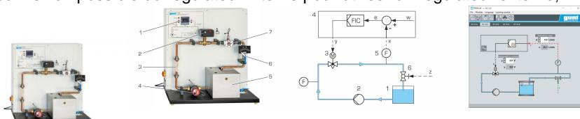
L'appareil d'essai constitue une introduction expérimentale étendue aux principes de base de la technique de régulation à l'exemple d'une régulation de débit.
