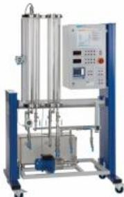
**RT 306 Banc d'étude des capteurs de niveau, capacitifs, piezorésistif (Réf. 080.30600)**
