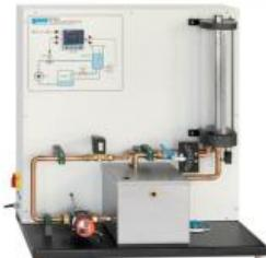
**Déconnexion possible du régulateur interne pour utiliser un régulateur externe, mesure par fiche 4mm**
