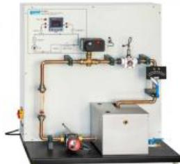
**Déconnexion possible du régulateur interne pour utiliser un régulateur externe, mesure par fiche 4mm**
