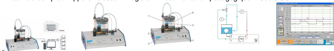
Le RT 020 propose des essais de base sur un système réglé de débit.
