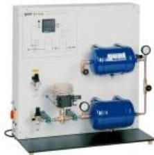
Déconnexion possible du régulateur interne pour utiliser un régulateur externe, mesure par fiche 4mm
