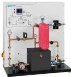
L'appareil d'essai constitue une introduction expérimentale étendue aux principes de base de la technique de régulation à l'exemple d'une régulation de température.
