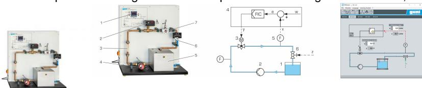
L'appareil d'essai constitue une introduction expérimentale étendue aux principes de base de la technique de régulation à l'exemple d'une régulation de débit.
