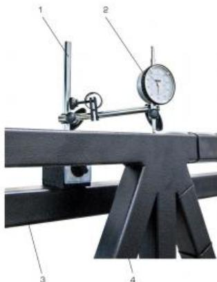
Ce jeu de comparateurs mécaniques à cadran permet de mesurer précisément les distances mécaniques. Il sert également à mesurer le fléchissement, les déplacements ainsi que les distances. Les comparateurs à cadran sont utilisés pour les essais dans le bâti SE 100. À l'aide d'une embase magnétique, les comparateurs à cadran sont positionnés à l'endroit souhaité.
