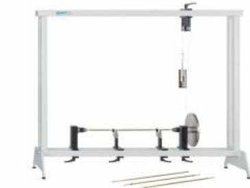
La torsion apparaît avant tout au niveau des axes et des arbres entraînement des véhicules et des machines. Les sections de l'arbre sont poussées l'une contre l'autre autour de l'axe longitudinal en raison des couples de rotation de l'arbre.
