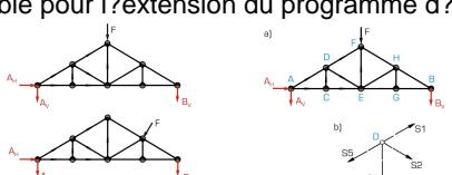
Comme construction légère avec rigidité élevée, les treillis trouvent principalement leur application dans la construction de halles, de ponts, de grue et de pylône.
