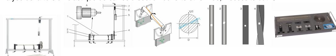
La torsion apparaît avant tout au niveau des axes et des arbres entraînement des véhicules et des machines. Les sections de l'arbre sont poussées l'une contre l'autre autour de l'axe longitudinal en raison des couples de rotation de l'arbre.
