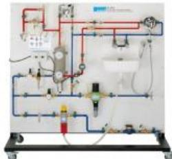
Sur le panneau de l'appareil d'essai est montée une installation d'eau potable comparable aux installations domestiques habituelles.
