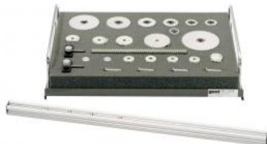
Le jeu complémentaire TM 110.03 élargit la gamme des essais du TM 110: rapport de transmission, de rotations et des moments au niveau d'un engrenage à un ou plusieurs étages et influence des roues intermédiaires sur le sens de rotation.
