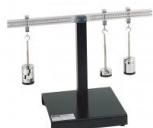
Le EM 049 permet d'étudier les principes de l'équilibre des moments en prenant l'exemple d'un levier à deux bras. Les moments créés au niveau du levier doivent être équilibrés.
