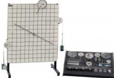
**Equilibre des forces, des moments, de la décomposition des forces, du principe de levier**
