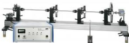
Des vibrations de torsion sont souvent observées dans les systèmes dentraînement.
