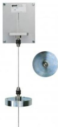
Lors des vibrations de torsion, un moment de redressement est produit par la torsion d'une barre du système vibrant; ce moment tend à ramener la masse en rotation vers sa position de repos.
