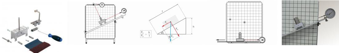
Le jeu complémentaire TM 110.01 élargit la gamme des essais du TM 110 avec les sujets allongement élastique d'un ressort hélicoïdal, forces au niveau du plan incliné et frottement.
