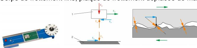
L'appareil permet de effectuer des essais de base sur le frottement dadhérence et le frottement de glissement. Deux corps solides sont déplacés l'un par rapport à l'autre de manière uniforme.
