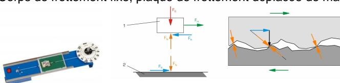
L'appareil permet de effectuer des essais de base sur le frottement dadhérence et le frottement de glissement.
