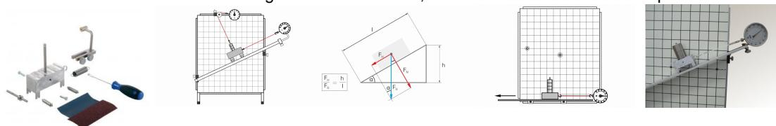
Le jeu complémentaire TM 110.01 élargit la gamme des essais du TM 110 avec les sujets allongement élastique d'un ressort hélicoïdal, forces au niveau du plan incliné et frottement.
