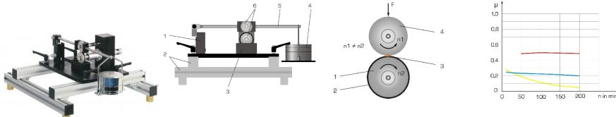
En technique de palier et dentraînement, des frottements dynamiques apparaissent aux endroits de glissement et de roulement, et entraînent des pertes de performance des systèmes techniques.
