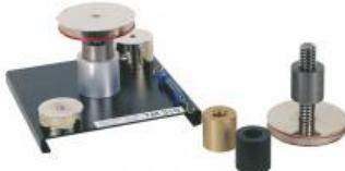
L'appareil de base est constitué pour l'essentiel d'un couplage broche filetée - écrou en position verticale. Un couple est exercé sur une broche par le biais d'une poulie, à l'aide de la balance à ressort et du câble. Des poids additionnels sur le plateau rotatif influent sur la charge axiale du fillet.
