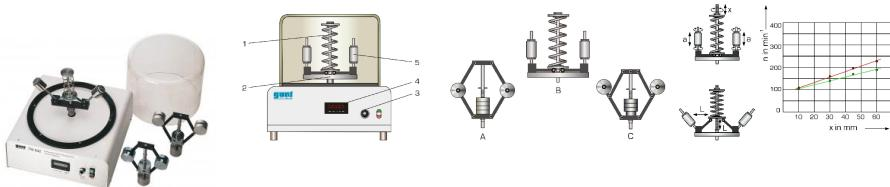
Les régulateurs centrifuges utilisent les propriétés de la force centrifuge pour réguler la vitesse de rotation d'une machine.
