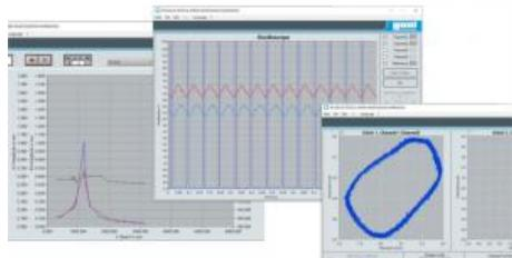
Le système d'acquisition de données TM 620.20, utilisé comme accessoire avec les appareils dessai TM 620 et TM 625, permet lenregistrement et l'évaluation des vibrations.
