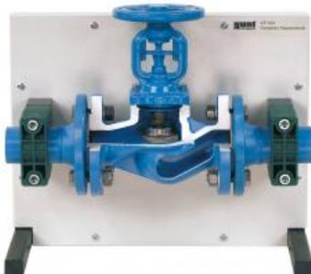
Véritable robinet à soupape transformé en modèle en coupe.
