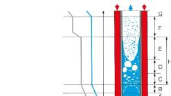
Lors de la production de vapeur, le milieu à évaporer passe par différentes formes d'écoulement en fonction de la zone de transfert de chaleur.
