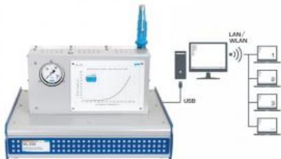
Dans un système fermé avec remplissage de liquide, un équilibre thermodynamique s'établit entre le liquide et sa phase à l'état de vapeur.
