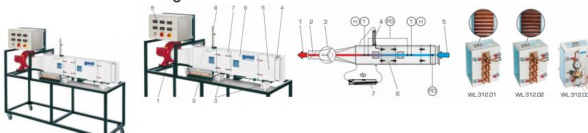
Le banc d'essai est constitué d'un canal isolé, à travers lequel de l'air est aspiré à l'aide d'un ventilateur.
