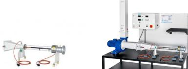
L'accessoire WL 314.01 permet d'étendre les possibilités d'essai du WL 314 à la thématique: transfert de chaleur convectif à l'intérieur d'un tube et sur un tube, dans le cas d'un écoulement parallèle.
