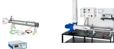
L'accessoire WL 314.03 permet d'étendre les possibilités d'essai du WL 314 à la thématique: transfert de chaleur convectif à l'intérieur d'un tube.
