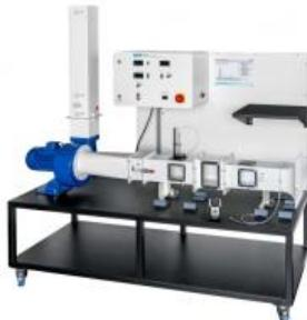
On appelle transfert de chaleur convectif le transfert de chaleur entre une surface et un fluide. Les processus de transfert de chaleur convectif sont associés aux mouvements du fluide, c'est-à-dire à la convection.
