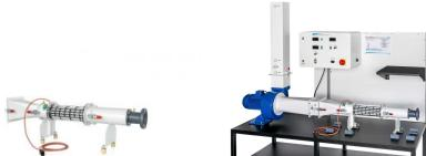
L'accessoire WL 314.02 permet d'étendre les possibilités d'essai du WL 314 à la thématique: transfert de chaleur convectif avec un écoulement mélangé.
