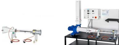
L'accessoire WL 314.01 permet d'étendre les possibilités d'essai du WL 314 à la thématique: transfert de chaleur convectif à l'intérieur d'un tube et sur un tube, dans le cas d'un écoulement parallèle.
