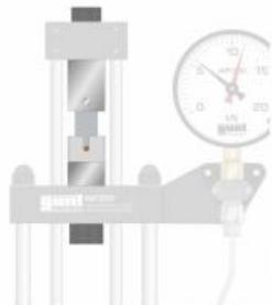
Cet accessoire, conçu pour l'appareil d'essai WP 300, permet de réaliser des essais de cisaillement à simple section.
