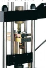
Ce dispositif complémentaire à la machine d'essai universelle WP 300 permet d'effectuer des essais d'emboutissage pour l'évaluation des propriétés des tôles fines.
