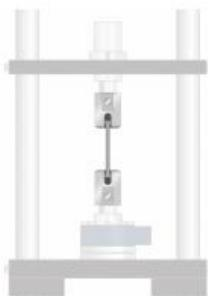
Cet accessoire, conçu pour l'appareil dessai WP 310, permet de réaliser des essais de traction sur des éprouvettes cylindriques.
