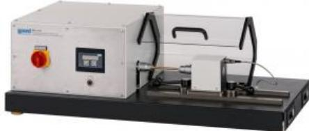
Lessai de torsion fait partie des méthodes dessai destructif, et étudie le comportement plastique des matériaux. Dans la pratique, on se sert de cette méthode dessai pour tester des composants qui sont tordus pendant leur utilisation, comme par exemple les vis, arbres, axes, fils et ressorts.
