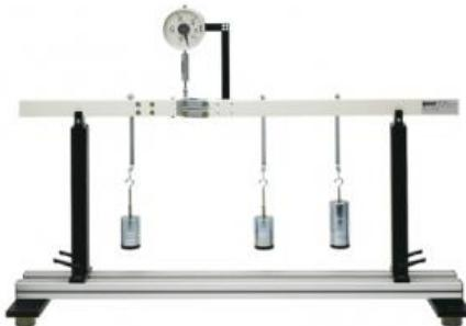
Le WP 961 se compose d'une poutre sur deux supports qui est soumise à des charges ponctuelles. La poutre est coupée à un endroit où se situe une articulation à faible frottement avec un degré de liberté.
